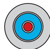
koaksijalna cijev u cijevi
